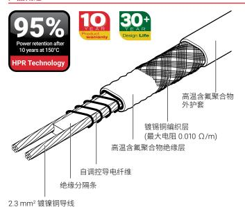
RAYCHEM XTVR自调控伴热线设计用于防冻或工艺维温,适用 于需要高功率输出和高暴露温度的管道和容器。
