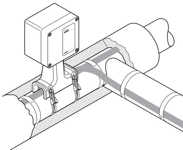
RAYCHEM T-100 是一种外置式两通或三通连接套件，设计用于和最多三根RAYCHEM BTV、CTV、QTVR、RTV、XTV、XTVR、HTV、VPL工业并联伴热线配套使用。经认证可用于危险区域。
