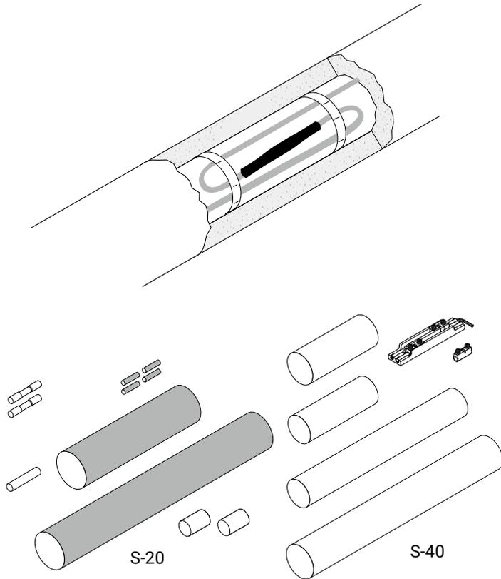
该系列两通套件适用于RAYCHEM自调控伴热线的串联连接。
