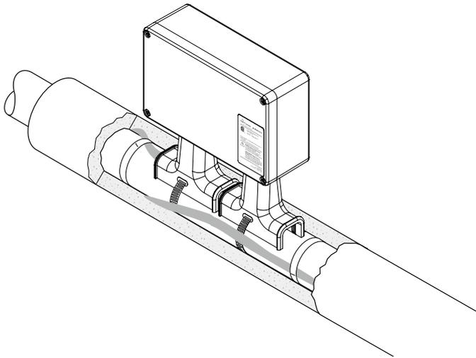
nVent RAYCHEM JB-SPLICE-PI-E套件设计用于将nVent RAYCHEM XPI工业串联电阻式伴热线进行两通连接，无需使用冷端线，并且具有一定的功率和电流限制。
