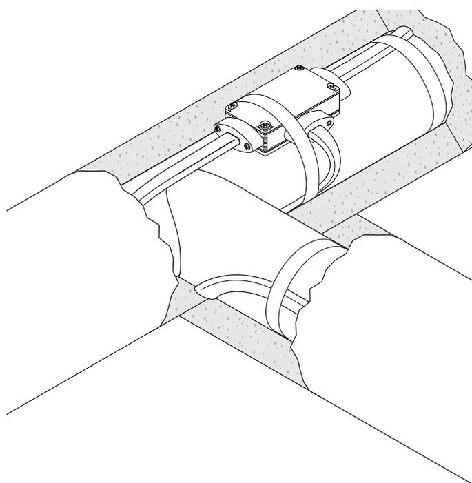
RAYCHEM PMKG-LTC是用于 RAYCHEM BTV、CTV、QTVR、RTV自调控伴热线的三通接线盒，符合IEC标准。安装时固定于管道上，外面包有保温层，三通连接所用材料均可放于盒内。
